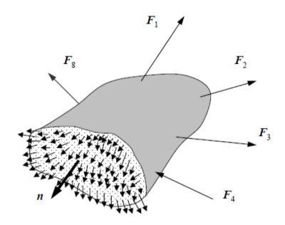
Forças internas de ligação (forças de superfície) mantêm as duas partes do corpo em equilíbrio
