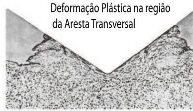
Figura 3.4: Análise das deformações na aresta transversal de corte (Smith, 2008)
